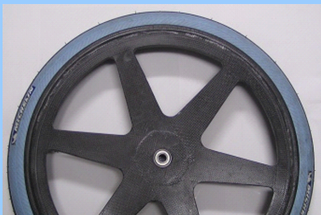
ディスクの駄肉抜きで前方視界確保と軽量化
